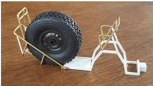
Bei der Pritsche habe ich gegenüber dem Bausatz zusätzliche Verstrebungen angebracht. Die Heckklappe ist beweglich ausgeführt. Zur Arretierung habe ich einfache Riegel angebracht.
