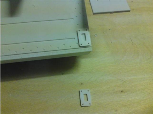
step2: Das T-Profil kommt auf die dünnen Ausfräsungen. Die beiden Halbleche für die Kotflügelstütze werden nach den Bohrungen ausgerichtet /
